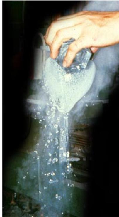
Abb. 8 Die noch heiße Schüssel wird außen mit Wasser übergossen und zerspringt. Die Glasbröckchen fallen herab, und zurück bleibt der Trichter mit eingeschmolzener Glasblase.
